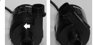
5. Neem de pompadekking af en trek het schoepenwiel met de standas uit de pomp.
