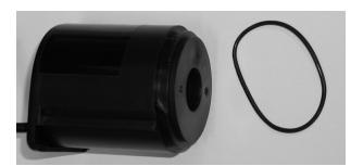
7. Retirez un capuchon en caoutchouc du palier de l'arbre puis retirez ce dernier du rotor. L'extrémité avant (du rotor) comporte plusieurs rondelles de calage. Durant l'assemblage ultérieur, ces dernières doivent être remontées au même emplacement. La puissance de la pompe pourrait sinon diminuer ou le rotor ne tournerait pas.
