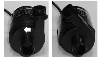
5. Nehmen Sie die Pumpenabdeckung ab und ziehen Sie das Flügelrad mit der Lagerwelle aus der Pumpe heraus.
