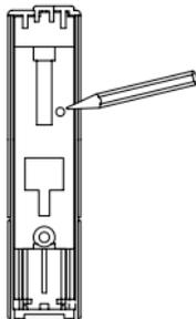
Um den Tür-Fensterkontakt in den Anlernmodus zu bringen, drücken Sie mit einem spitzen Gegenstand auf die Anlerntaste. Die Geräte-LED blinkt orange. (Abbruch durch kurze Betätigung der Anlerntaste, die Geräte-LED leuchtet dann rot auf.)
