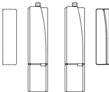
Die Montageebenen der beiden Einheiten (A und B) sollten übereinstimmen! Um dies zu erreichen montieren Sie unter dem Magneten ein oder mehrere der mitgelieferten Distanzstücke (nur Schraubmontage).
