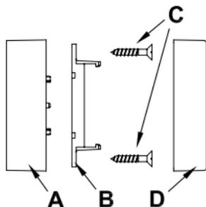
Abschließend schieben Sie die Abdeckung (D) des Magneten bis zum Einrasten auf die Magnethalterung.
