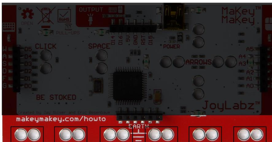
Nun können Sie eine weitere Krokodil-Klemme nehmen und an die vorgesehenen Löcher für die unterschiedlichen Tasten anstecken (z.B. „Space“ für die Leertaste). Das andere Ende befestigen Sie dann an dem Objekt, welches Sie für die Steuerung verwenden möchten (z.B. eine Banane).
