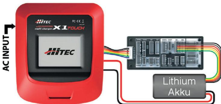
Schließen Sie den Akku über das Balancer Board an das Ladegerät an, um die Spannung jeder einzelnen Zelle zu erfahren.
