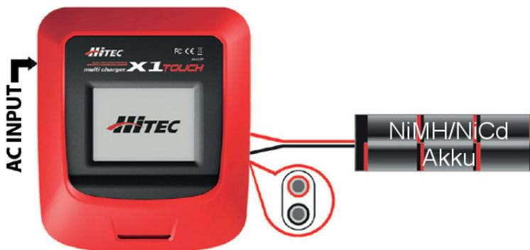
Schließen Sie den Akku direkt an das Ladegerät an um nur die gesamte Spannung des Akkus zu erfahren.
