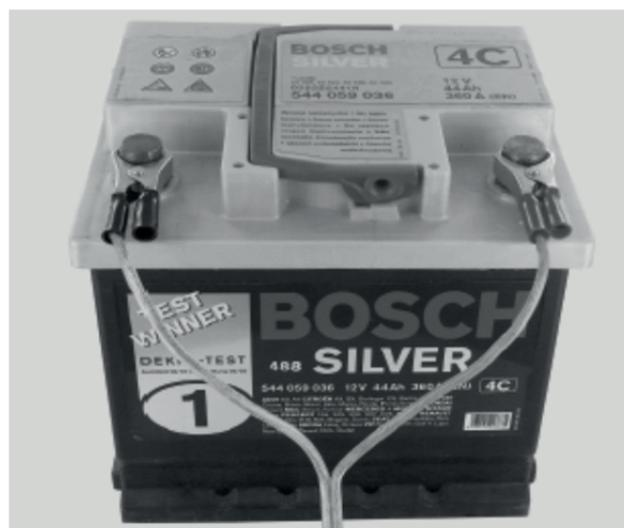
Anschluss mit dem beiliegenden 12V Anschlusskabel an eine Autobatterie (Polklemmen optional)
