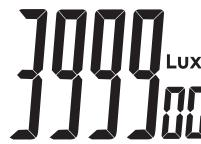
→ Wenn Sie die Taste „LX/FC/CD“ (3) länger als 1 Sekunde drücken, gelangen Sie zum Messmodus für die Lichtstärke (Einheit „cd“, Candela), siehe nächster Abschnitt c).
