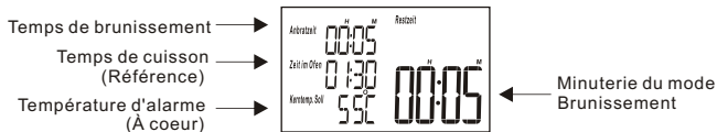
Fig. 2 – Informations relatives à la cuisson affichées dans le cas d'une combinaison de cuisson RI 1
