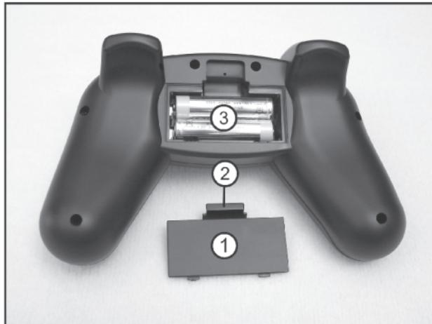
Die Bedienung des Senders mit aufladbaren Batterien wird nicht empfohlen aufgrund der niedrigeren Zellenspannung (Batterie = 1,5V, aufladbare Batterie = 1,2 V) und dem Selbstentladen von aufladbaren Batterien. Eine schnelle Rückkopplung des Senders bei niedrigem Ladezustand der Senderspannung wäre die Folge.
