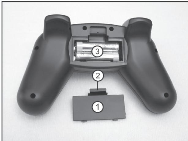
電池電圧が低(乾電池=1.5V、蓄電池=1.2V)く、蓄電池は自己放電が大きいので、送信機に蓄電池をお使いいただくことは推奨できません。送信機電源の低電圧状態表示が作動します。
