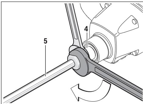
Avitare la frusta di miscelazione **5** nella vite di azionamento **4**, trattenendo la vite di azionamento **4** con una chiave fissa (GRW 12 E: ampiezza chiave 22 mm, GRW 18-2 E: ampiezza chiave 24 mm) e serrando con una seconda chiave fissa (ampiezza chiave 22 mm oppure 24 mm) la frusta di miscelazione **5**.
