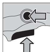
Para **enclavar** el interruptor de conexión/desconexión **2** apretado, oprima la tecla de enclavamiento **3**.
