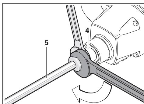
Aparafuse a barra misturadora **5** no veio de accionamento **4**. Para tal segure o veio de accionamento **4** com uma chave de bocas (GRW 12 E: tamanho 22 mm, GRW 18-2 E: tamanho 24 mm), e aperte a barra misturadora com uma segunda chave de bocas (tamanho 22 mm ou 24 mm) **5**.
