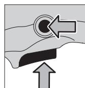
Voor het **vastzetten** van de ingedrukte aan-/uitschakelaar **2** drukt u op de vastzettoets **3**.
