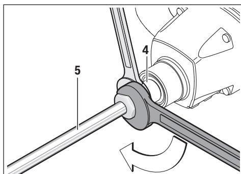
Schrauben Sie den Rührkorb **5** in die Antriebsspinde **4**. Halten Sie dazu die Antriebsspinde **4** mit einem Gabelschlüssel (GRW 12 E: Schlüsselweite 22 mm, GRW 18-2 E: Schlüsselweite 24 mm), und ziehen Sie mit einem zweiten Gabelschlüssel (Schlüsselweite 22 mm oder 24 mm) den Rührkorb **5** fest.
