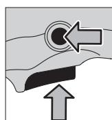
Pour **bloquer** l'interrupteur Marche/Arrêt **2** en position de marche, actionnez le bouton de blocage **3**.
