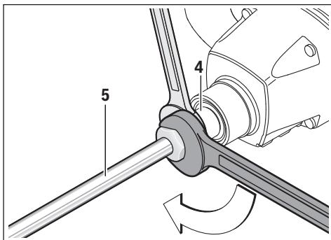
Schroef de menggarde **5** in de aandrijfspil **4**. Houd hiervoor de aandrijfspil **4** met een steeksleutel vast (GRW 12 E: sleutelwijdte 22 mm, GRW 18-2 E: sleutelwijdte 24 mm) en draai met een tweede steeksleutel (sleutelwijdte 22 mm of 24 mm) de menggarde **5** vast.
