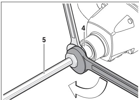
Visez le malaxeur **5** dans l'arbre d'entraînement **4**. Bloquez pour cela l'arbre d'entraînement **4** avec une clé plate (GRW 12 E : clé de 22 mm, GRW 18-2 E : clé de 24 mm) et serrez le malaxeur **5** avec une seconde clé plate (de 22 mm ou de 24 mm).
