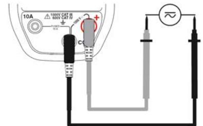
6. Standardmäßig erscheint die Frequenz der gemessenen Spannung in der Zweitanzeige (außer bei DC-Spannungen).
