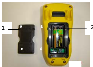
Figure 6 : accès à la pile
