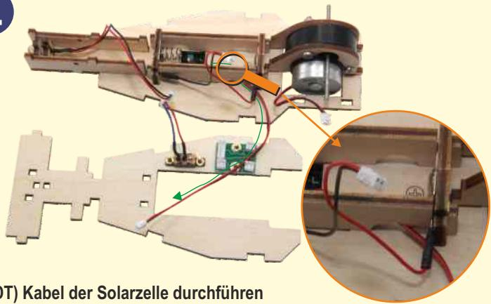
(DT) Kabel der Solarzelle durchführen
