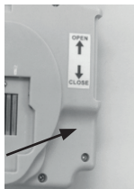
Position der Öffnung für die Rückstelltaste RESET .
