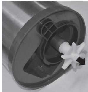
La turbine de la pompe se laisse ensuite retirer (flèche noire dans la figure de droite). Ici, il y a une certaine résistance à vaincre en raison de la force magnétique avant de pouvoir retirer la turbine de la pompe.
