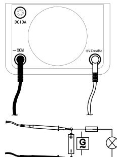
Zur Messung von Wechselspannungen (AC) gehen Sie wie folgt vor:
