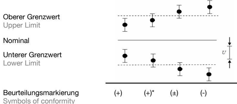
Angegeben ist die erweiterte Messunsicherheit  $U$ , die sich aus der Standardmessunsicherheit durch Multiplikation mit dem Erweiterungsfaktor  $k = 2$  ergibt. Sie wurde gemäß DAkkS-DKD-3 ermittelt. Der Wert der Messgröße liegt mit einer Wahrscheinlichkeit von 95 % im zugeordneten Wertebereich.
