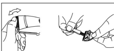
**4** Załącz głowice tnącą **A** najpierw wkładając pazur w zagłębienie i naciskając na głowicę tnącą aż kliknie w swoim miejscu.
