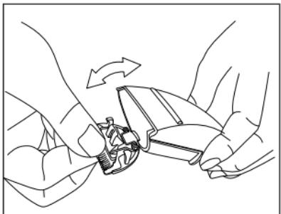
**2** Zdejmij grzebień regulowany 1 **D** lub 2 **G** z maszynki. Oczyść głowicę tnącą **A** załączoną **J** szczoteczką.
