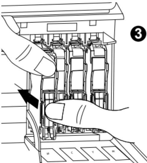
Cuando el cartucho esté vacío, por favor tirar de la palanca (A) hacia arriba y sacar el cartucho de la impresora utilizando la lengüeta (B).
