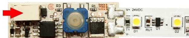
3. Führen Sie das Anschlußkabel durch die PG-Verschraubung bzw. Endkappe des Profils. Entfernen Sie nun den Schutzfilm auf der Rückseite des Profile Switch Dimmers und LED-Streifens und befestigen Sie beides mittig im Aluprofil möglichst nah an der Endkappe.
