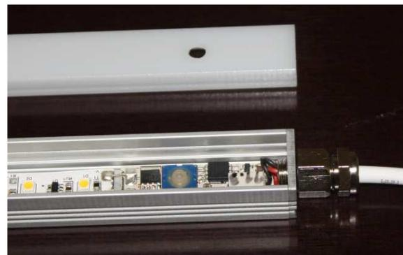
4. Markieren Sie die Stelle an der Kunststoffabdeckung, die sich direkt über der Stößelaufnahme des Mikroschalters befindet und bohren Sie an diese Stelle ein Loch  $\varnothing 4\text{mm}$  in die Abdeckung (Vorsicht: Kunststoff bricht leicht; am Besten die Abdeckung zum Bohren plan auf einen Holz-scheit o. Ä. auflegen)
