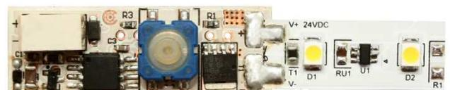
2. Schließen Sie das Anschlußkabel an die Anschlußklemme an (s. Pfeil/Polarität beachten)
