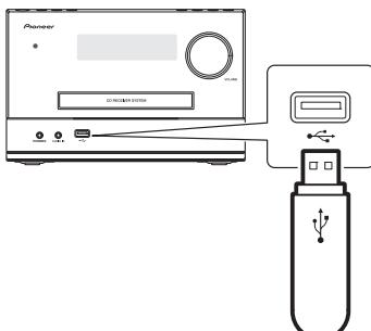
**1 Schließen Sie das USB-Gerät an die Buchse USB an.**
