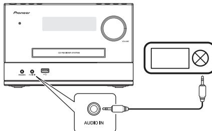
**1 Raccordez un câble à minifice stéréo (en vente dans le commerce) à**
