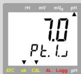
Stellen Sie die Elektrode und den Temperaturfühler (falls vorhanden) in die neutrale Lösung und rühren Sie vorsichtig um.
