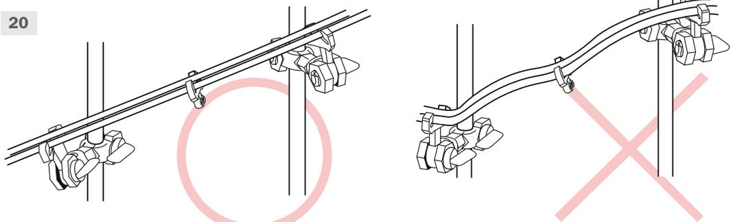
Erzeugen Sie ein Gefälle durch ein Versetzen der Arme
