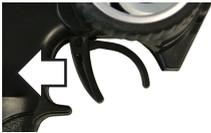
3. Rouler en marche avant puis freiner (le véhicule freine, il ne ralentit pas), repousser le levier d'accélération / de freinage de la poignée sans pause
