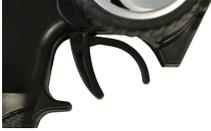
2. Rouler en marche avant, tirer lentement le levier d'accélération / de freinage en direction de la poignée
