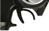
2. Vooruit rijden, gas-/remhendel langzaam in de richting van de greep trekken
