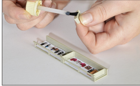
2. Trennwände zur Lichtabschottung zwischen Fenstern und Türen sowie als Endabschluss.
