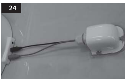
24 Anslut svart kabel till kontrollenheten (höger) och grå kabel till mottagaren (vänster).
