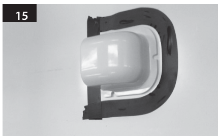
Placera kabelhuset framför (30cm från) antenn centrum med öppna sidan av kabelhuset vänd motanslutningarna på antennen. Fäst sedan skyddstejp runt kabelhuset.
