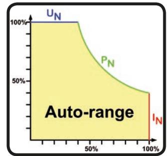
Konstantleistungsbetrieb wirkt auf den internen Stromsollwert ein. Das bedeutet, der als maximal eingestellte Strom kann unter Umständen nicht erreicht werden, wenn der Leistungssollwert nach  $I = P / U$  einen geringeren Strom bewirkt und das Gerät auf diesen begrenzt. Der vom Anwender eingestellte und auf dem Display angezeigte Stromsollwert ist stets nur eine obere Grenze.
