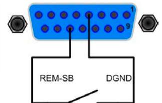
Dieser Eingang wird bei Fernsteuerung zum Ein- und Ausschalten des DC-Ausganges des Gerätes genutzt, kann ab KE-Firmwareversion 2.03 aber auch ohne aktivierte Fernsteuerung genutzt werden.
