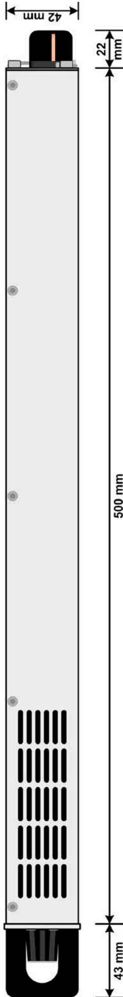
Bild 4 - Seitenansicht von rechts, ohne DC-Abdeckung
