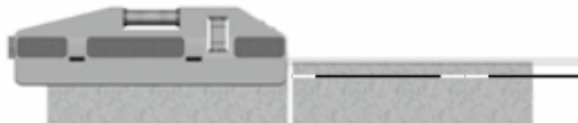
Pentru montarea faianței aparatul se introduce în prima placă de faianță cu ajutorul suportului de prindere cu arcuri prin șifturile de pe partea posterioară cu ajutorul căruia se poate împinge afară. Raza laser aflată paralel cu nivela orizontală trece de-a lungul cantului plăcii de faianță. Astfel placă de faianță se poate alinia exact cu ajutorul nivelei.
