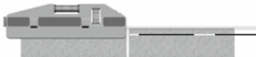
Для укладки плитки для облицовки стен прибор закрепляют на первой плитке с помощью пружинного зажимного крепления, которое выдвигается за счет расположенных с обратной стороны штифтов. Лазерный луч, проходящий параллельно горизонтальному пузырьку в уровне, ведет вдоль края плитки. Так плитку можно выровнять точно по уровню.
