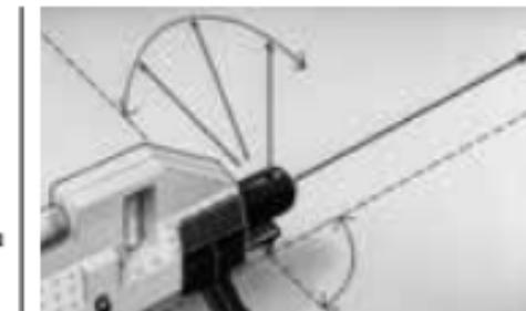
A 90°-os sugárosztóval a lézersugár 90°-ban eltéríthető.
