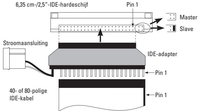
→ In de IDE-adapter bevindt zich geen elektronica, echter converteert hij alleen de verschillende gevormde aansluitingen en verstrekke de spannings-/stroomtoevoer van de kleine 6,35 cm/2,5"-hardeschijf (5 V/DC via pc-netvoeding).
