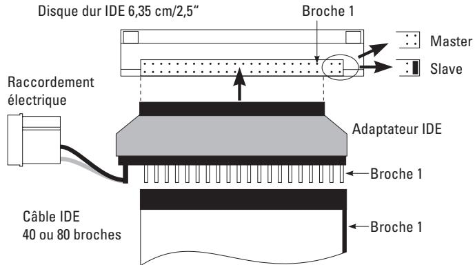
→ L'adaptateur IDE ne contient pas de circuit électronique, mais convertit uniquement les différents raccords et assure l'alimentation du petit disque dur 6,35 cm/2,5" (5 V/CC via le bloc d'alimentation de l'ordinateur).
