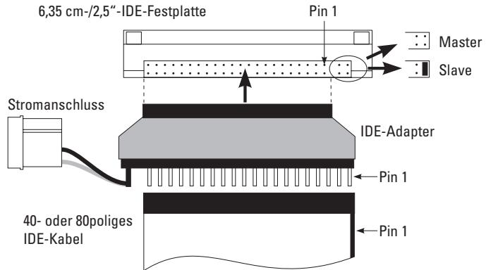
→ In dem IDE-Adapter ist keine Elektronik enthalten, sondern er wandelt nur die verschiedenen geformten Anschlüsse um und stellt die Spannungs-/Stromversorgung der kleinen 6,35 cm-/2,5"-Festplatte her (5 V/DC über PC-Netzteil).
