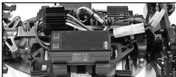
Lors du montage, veillez à ne pas recouvrir les orifices du haut-parleur. Comme l'électronique chauffe lorsque le volume est élevé, également veiller à ce que celle-ci soit suffisamment refroidie.
