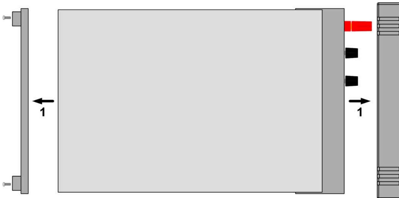
Bild 8 - Abnehmen des Front- und Rückseitenrahmens
