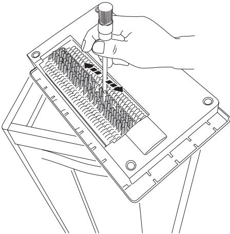
**RU** Периодически очищайте режущий механизм аппарата.
