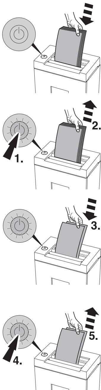
**PT A máquina pára automaticamente se tiver demasiado ou papel inserido.**
