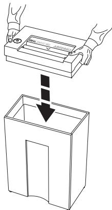
**RU** Установите механизм на корпус аппарата.
