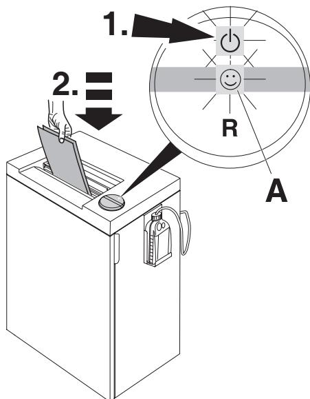
**RU** Нажмите переключатель (1.): загорится зеленый светодиод, машина снова готова к работе. Машина автоматически начнет работать (2.), если поместить бумагу в приемный слот. Машина автоматически переходит в режим ожидания через 30 минут. Машина может быть выключена в любое время, удерживая выключатель в течение 2 секунд. Зеленый светодиод не горит. Не будет никакого потребления электроэнергии.
