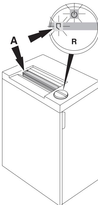
**RU** Аппарат автоматически остановится, если шторка безопасности (A) открыта (индикаторы и будут загораться поочередно). Закройте шторку безопасности и нажмите кнопку - аппарат продолжит уничтожать бумагу. Машина может работать некоторое время в реверсном направлении с открытой шторкой безопасности, если Вам необходимо удалить обрезки бумаги или произошло ее замятие.
