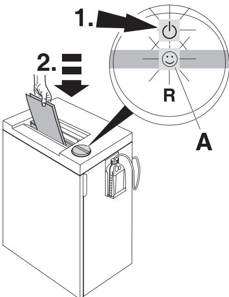
**PL** Naciśnij przycisk (1.). Zielona lampka informuje, że urządzenie jest gotowe do pracy. Uruchomienie następuje automatycznie po wprowadzeniu dokumentu do otworu wejściowego (2.). Automatyczny przycisk stanu gotowości wyłącza urządzenie po 30 minut. Urządzenie może być wyłączone w każdej chwili. Przyciśnij przycisk (1) i przytrzymaj przez 2 sekundy. Gaśnie zielona dioda LED (1). Urządzenie wyłączy się i nie będzie pobierało już energii.
