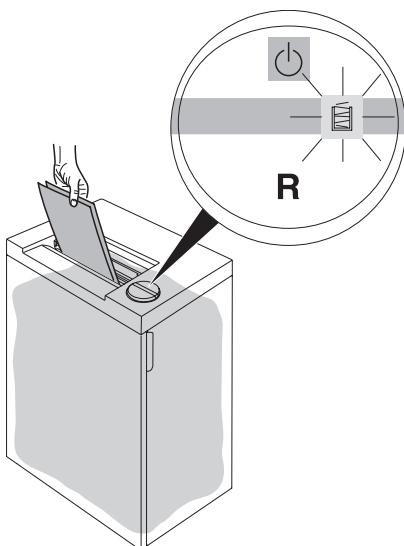
**RU** При заполнении пластикового мешка аппарат остановится автоматически. Должен загореться индикатор "мешок заполнен". Замените пластиковый мешок. (смотри стр. 10).
