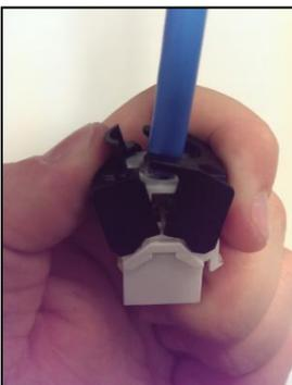
Schließen Sie die Außenkappe, indem Sie beide Seiten der Außenkappe zusammendrücken, bis es klickt.
