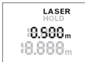
Druk opnieuw op de „HOLD”-toets **2** om de laser opnieuw in te schakelen. De indicatie **LASER** knippert op het display. In de bovenste regel wordt de vorige meetwaarde weergegeven. In de onderste regel wordt de permanent geactualiseerde/actuele meetwaarde weergegeven.
