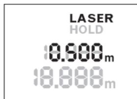
Trykk på «HOLD»-knappen **2** igjen for å slå på laseren på nytt. **LASER** blinker på displayet. Den foregående måleverdien vises i den øvre raden den nedre raden vises den kontinuerlig oppdaterte/aktuelle måleverdien.
