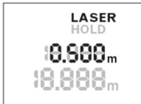
Premere nuovamente il tasto «**HOLD**» **2** per riattivare il laser. Sul display lampeggerà l'indicazione **LASER**. Nella riga in alto verrà visualizzato il valore di misurazione precedente. Nella riga in basso verrà visualizzato il valore aggiornato in modo continuo/il valore attuale.
