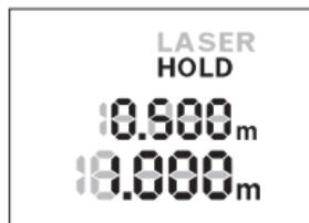
Trykk på «HOLD»-knappen **2** en gang til for å stoppe målingen på nytt. Laserstrålen slås av, og **HOLD** vises på displayet. Den foregående måleverdien vises i den øvre raden Den gjeldende måleverdien vises i den nedre raden, men den oppdateres ikke kontinuerlig.
