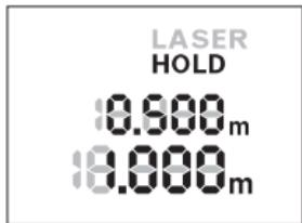
Pour interrompre une nouvelle fois le processus de mesure, actionnez à nouveau la touche « HOLD » **2**. Le faisceau laser s'éteint et l'affichage **HOLD** apparaît à l'écran. La valeur de mesure précédente s'affiche sur la ligne supérieure. La valeur de mesure actuelle s'affiche sur la ligne inférieure de l'écran mais elle n'est plus actualisée.
