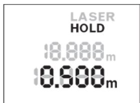
“HOLD” 버튼 2를 누르면 측정 과정이 종료됩니다. 레이저빔이 꺼지고 디스플레이에 **HOLD** 표시가 나타납니다. 현재 측정값이 계속해서 디스플레이 하단에 표시되지만, 지속적으로 업데이트되지는 않습니다.
