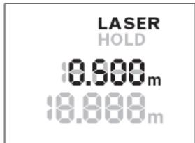
Pour réactiver le faisceau laser, actionnez à nouveau la touche « HOLD » **2**. L'affichage **LASER** clignote à l'écran. La valeur de mesure précédente s'affiche sur la ligne supérieure. Sur la ligne inférieure s'affiche la valeur de mesure actuelle (actualisée en permanence).
