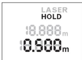
Premere il tasto «**HOLD**» **2** per arrestare la misurazione. Il raggio laser verrà disattivato e sul display comparirà l'indicazione **HOLD**. Il valore di misurazione attuale verrà ancora visualizzato nella riga in basso del display, ma non verrà più aggiornato in modo continuo.
