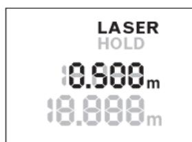
Πατήστε εκ νέου το πλήκτρο «HOLD» **2**, για να ενεργοποιήσετε ξανά το λέιζερ. Η ένδειξη **LASER** αναβοσβήνει στην οθόνη. Στην επάνω σειρά εμφανίζεται η προηγούμενη τιμή μέτρησης. Στην κάτω σειρά εμφανίζεται συνεχώς η ενημερωμένη/τρέχουσα τιμή μέτρησης.
