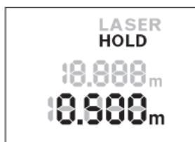
Ölçme işlemini durdurmak için “HOLD” tuşuna **2** basın. Lazer işini kapatılır ve ekranda gösterge **HOLD** görünür. Güncel ölçme değeri ekranın alt satırında gösterilmeye devam edilir, ancak sürekli olarak güncellenmez.
