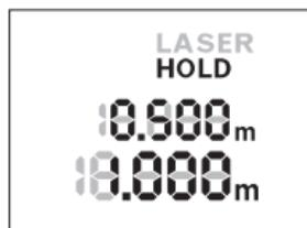
Πατήστε εκ νέου το πλήκτρο «HOLD» **2**, για να συγκρατήσετε ακόμα μια φορά τη διαδικασία μέτρησης. Η ακτίνα λέιζερ απενεργοποιείται και η ένδειξη **HOLD** εμφανίζεται στην οθόνη. Στην επάνω σειρά εμφανίζεται η προηγούμενη τιμή μέτρησης. Στην κάτω σειρά εμφανίζεται η τρέχουσα τιμή μέτρησης, αλλά δεν ενημερώνεται πλέον συνεχώς.
