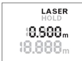
Presione de nuevo la tecla “HOLD” **2**, para conectar nuevamente el láser. La indicación **LÁSER** parpadea en el display. En la línea superior se indica el valor de medición precedente. En la línea inferior se indica el valor de medición actual/continuamente actualizado.
