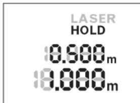
Drücken Sie die „HOLD“-Taste **2** erneut zum nochmaligen Anhalten des Messvorganges. Der Laserstrahl wird ausgeschaltet und die Anzeige **HOLD** erscheint im Display. In der oberen Zeile wird der vorhergehende Messwert angezeigt. In der unteren Zeile wird der aktuelle Messwert angezeigt, aber er wird nicht mehr dauernd aktualisiert.
