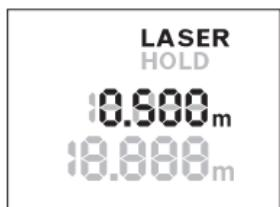
“HOLD” 버튼 2를 다시 누르면 레이저를 다시 켤 수 있습니다. 디스플레이에 **LASER** 표시가 깜박입니다. 상단에 기존 측정값이 표시됩니다. 하단에 지속적으로 업데이트된 / 현재 측정값이 표시됩니다.
