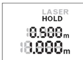
Ölçme işlemini tekrar durdurmak için “HOLD” tuşuna **2** yeniden basın. Lazer işini kapatılır ve ekranda gösterge **HOLD** görünür. Üst satırda bir önceki ölçme değeri gösterilir. Alt satırda güncel ölçme değeri gösterilir, fakat artık sürekli güncelleme yapılmaz.
