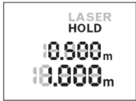
“HOLD” 버튼 2를 다시 한번 누르면 측정 과정이 다시 한번 종료됩니다. 레이저빔이 꺼지고 디스플레이에 **HOLD** 표시가 나타납니다. 상단에 기존 측정값이 표시됩니다. 현재 측정값이 하단에 표시되지만, 지속적으로 업데이트되지는 않습니다.
