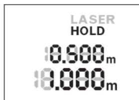
Druk opnieuw op de „HOLD”-toets **2** om de meting nogmaals te stoppen. De laserstraal wordt uitgeschakeld en de indicatie **HOLD** verschijnt op het display. In de bovenste regel wordt de vorige meetwaarde weergegeven. In de onderste regel wordt de actuele meetwaarde weergegeven, maar deze wordt niet meer permanent geactualiseerd.
