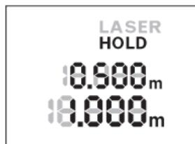
Premere nuovamente il tasto «HOLD» **2** per arrestare un'altra volta la misurazione. Il raggio laser verrà disattivato e sul display comparirà l'indicazione **HOLD**. Nella riga in alto verrà visualizzato il valore di misurazione precedente. Nella riga in basso del display verrà visualizzato il valore di misurazione attuale, ma esso non verrà più aggiornato in modo continuo.
