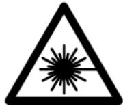
**Richten Sie den Laserstrahl nicht auf Personen oder Tiere und blicken Sie nicht selbst in den direkten oder reflektierten Laserstrahl.** Dadurch können Sie Personen blenden, Unfälle verursachen oder das Auge schädigen.
