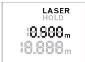
Tryk på „HOLD“-tasten **2** igen for at aktivere laseren igen. Visningen **LASER** blinker på displayet. På den øverste linje vises den forrige måleværdi. På den nederste linje vises den konstant opdaterede/aktuelle måleværdi.
