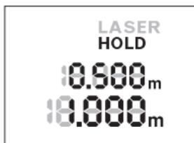
Presione de nuevo la tecla “HOLD” **2** para una repetida detención del proceso de medición. El rayo láser se desconecta y la indicación **HOLD** aparece en el display. En la línea superior se indica el valor de medición precedente. En la línea inferior se indica el valor de medición actual, pero no se sigue actualizando continuamente.
