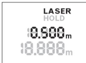
Drücken Sie die „HOLD“-Taste **2** erneut, um den Laser wieder einzuschalten. Die Anzeige **LASER** blinkt im Display. In der oberen Zeile wird der vorhergehende Messwert angezeigt. In der unteren Zeile wird der dauernd aktualisierte/aktuelle Messwert angezeigt.
