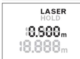
Lazeri tekrar açmak için “HOLD” tuşuna **2** yeniden basın. Göster **LASER** ekranda yanıp söner. Üst satırda bir önceki ölçme değeri gösterilir. Alt satırda sürekli olarak güncellenen/güncel ölçme değeri gösterilir.
