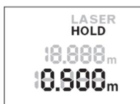
Πατήστε το πλήκτρο «HOLD» **2** για τη συγκράτηση της διαδικασίας μέτρησης. Η ακτίνα λέιζερ απενεργοποιείται και η ένδειξη **HOLD** εμφανίζεται στην οθόνη. Η τρέχουσα τιμή μέτρησης συνεχίζει να εμφανίζεται στην κάτω σειρά της οθόνης, αλλά δεν ενημερώνεται συνεχώς.
