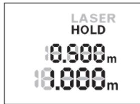
Volte a premir o botão “HOLD” **2** para voltar a interromper o processo de medição. O raio laser é desligado e a indicação **HOLD** surge no mostrador. O valor de medição anterior é indicado na linha superior. O valor de medição atual é indicado na linha inferior, mas já não é permanentemente atualizado.
