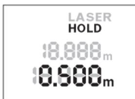
Presione la tecla “HOLD” **2** para detener el proceso de medición. El rayo láser se desconecta y la indicación **HOLD** aparece en el display. El valor de medición actual se sigue indicando en la línea inferior del display, pero no se sigue actualizando continuamente.
