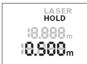
Drücken Sie die „HOLD“-Taste **2** zum Anhalten des Messvorganges. Der Laserstrahl wird ausgeschaltet und die Anzeige **HOLD** erscheint im Display. Der aktuelle Messwert wird weiterhin in der unteren Zeile des Displays angezeigt, aber er wird nicht mehr dauernd aktualisiert.
