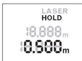
Prima o botão “HOLD” **2** para interromper o processo de medição. O raio laser é desligado e a indicação **HOLD** surge no mostrador. O valor de medição atual continua a ser indicado na linha inferior do mostrador, mas já não é permanentemente atualizado.
