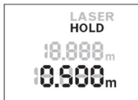
Druk op de „HOLD”-toets **2** om de meting te stoppen. De laserstraal wordt uitgeschakeld en de indicatie **HOLD** verschijnt op het display. De actuele meetwaarde wordt verder in de onderste regel van het display weergegeven, maar deze wordt niet meer permanent geactualiseerd.
