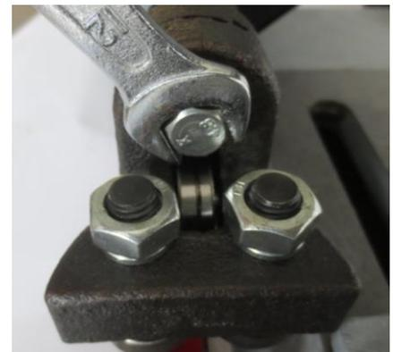
**HINWEIS:** Mit einer 90° Winkellehre oder mit einem rechtwinkligem Werkstück die 90° Stellung der Sägebandführung prüfen.
