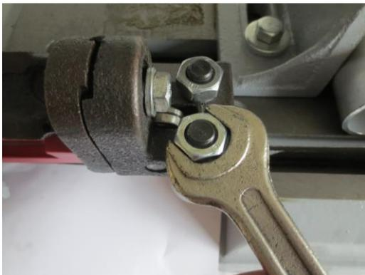
Die Muttern an beiden seitlichen Führungsrollen mit einem Gabelschlüssel **SW17** leicht lockern.
