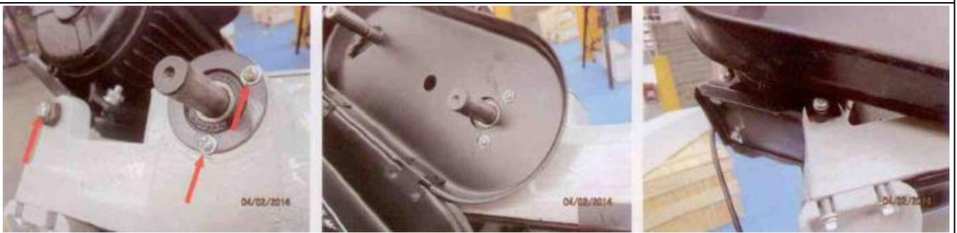
14. Die 2 Schrauben rechts und die Schraube aus der Motorbefestigung herausschrauben. Die Riemenabdeckung wie abgebildet anschrauben.
