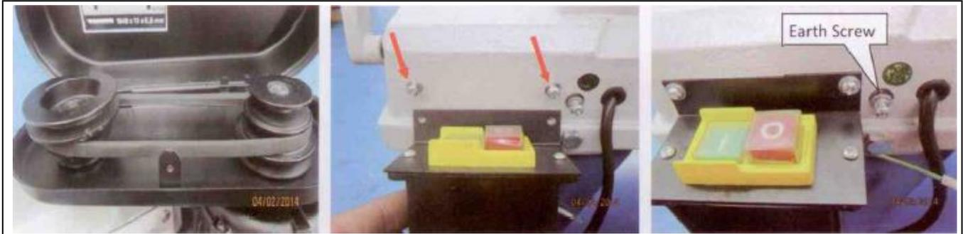
17. Den Keilriemen aufsetzen. 18. Die Schalteinheit anschrauben.
