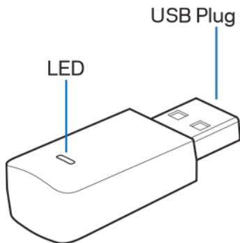
**Plug USB** - conecte este terminal a qualquer porta USB disponível no computador.
