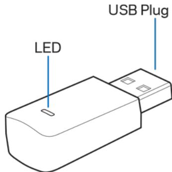
**USB-kontakt**-Anslut den här änden till ett ledigt USB-uttag på din dator.
