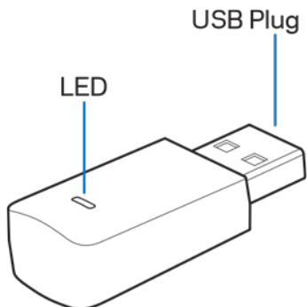
**USB-vtič**—Ta del priklopite v prosta vrata USB računalnika.
