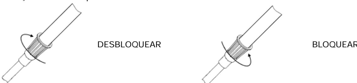
**Observação:** todos os fios das bobinas passam por dentro da haste. Não forçar para evitar danos.
