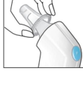
5. Voor een volgende meting verwijdert u het gebruikte lensfilter en plaatst u een nieuw, schoon lensfilter. Maak het display leeg door nogmaals op de «start»-knop te drukken. Plaats de lens voorzichtig in de gehoorgang en druk op de «start»-knop.
