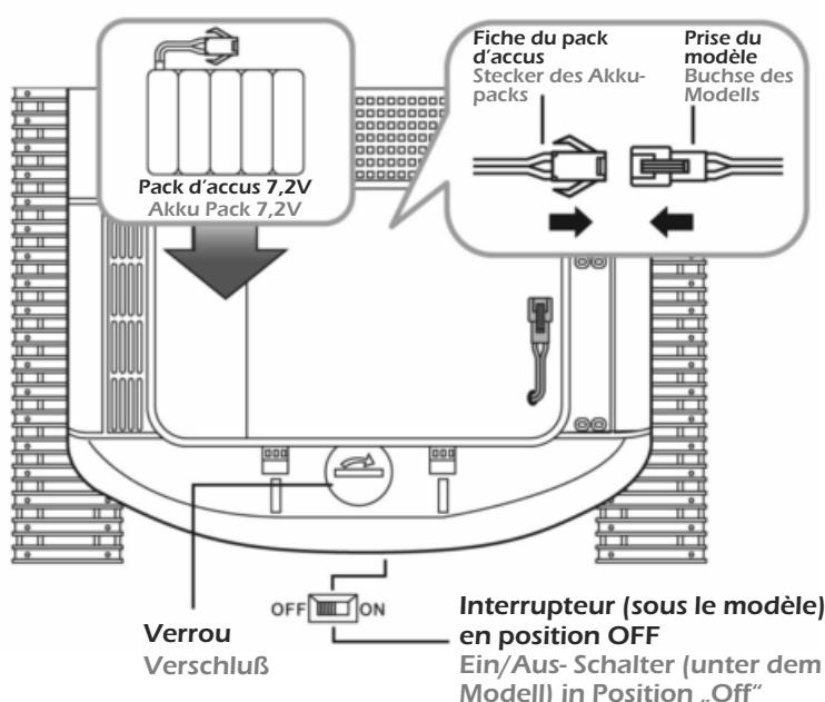
Enlever la trappe du logement de pack d'accus situé derrière la cabine du modèle en faisant préalablement pivoter le verrou. Connecter le pack à la prise du modèle puis l'installer dans le logement. Remettre en place la trappe et la bloquer en pivotant le verrou dans l'autre sens.
