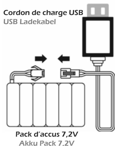
Connecter le pack d'accus 7,2V au cordon de charge USB inclus. Connecter le cordon à toute source d'alimentation USB (ordinateur, adaptateur USB pour prise murale - exemple T2M SMART PLUG Réf. T1275).
