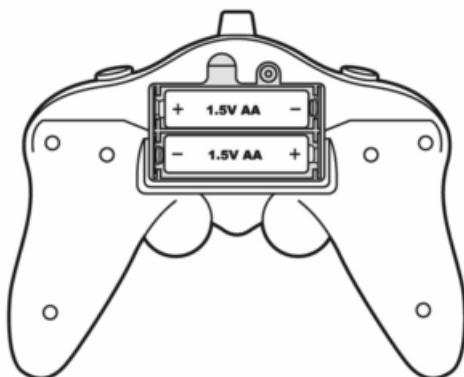
Ouvrir la trappe situé sur l'arrière de l'émetteur en enlevant la vis. Insérer 2 piles 1,5V AA en respectant les polarités. Remettre en place la trappe et sécuriser à l'aide de la vis.
