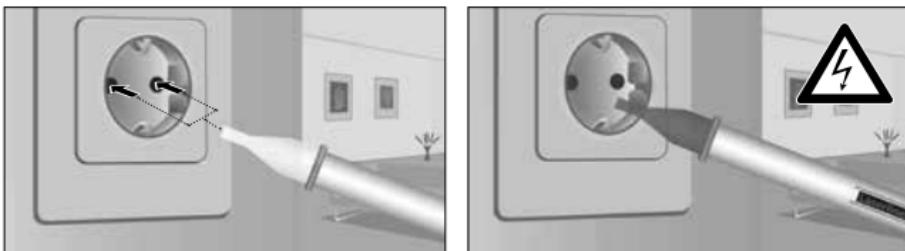
Poser la pointe du détecteur sur la zone à contrôler (par ex. câble, prise, etc.).
