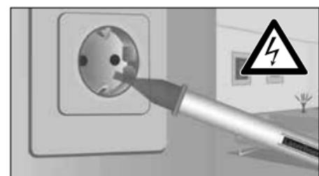
Ist Spannung vorhanden, leuchtet die Detektorspitze.
