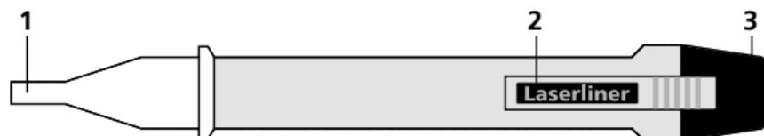
**1** Detektorspitze      **2** Taschenclip      **3** Batteriefach
