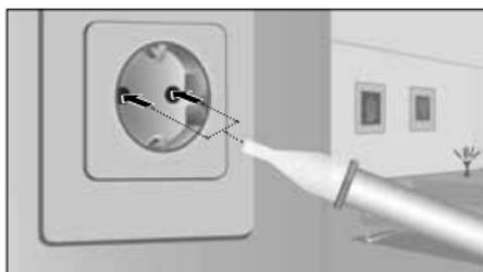
Plaats de detectorpunt op het te controleren bereik (bijv. kabel, contactdoos, enz.).
