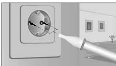
Mettere la punta del rilevatore sulla zona da controllare (p.e. cavo, presa, ecc.).
