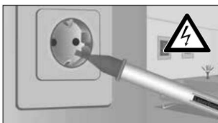
Hvis der findes en spænding, lyser detektorspidsen.
