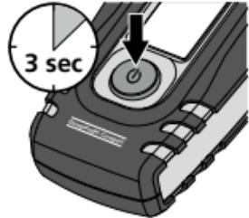
После включения прибора на экране в течение 3 секунд появляются показания температуры окружающей среды.
