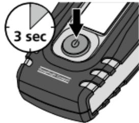
Після вмикання приладу на дисплей на 3 секунди виводиться температура навколошнього середовища.
