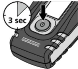
След включване на прибора на дисплея в продължение на 3 секунди се появява температурата на обкръжението.
