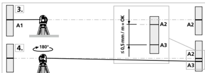
**!** Jos A2 ja A3 ovat toisistaan etäimmällä kuin 0,5 mm / m, on säätö tarpeen. Ota yhteys paikalliseen laitetoimittajaan tai UMAREX-LASERLINER huolto-osastoon.
