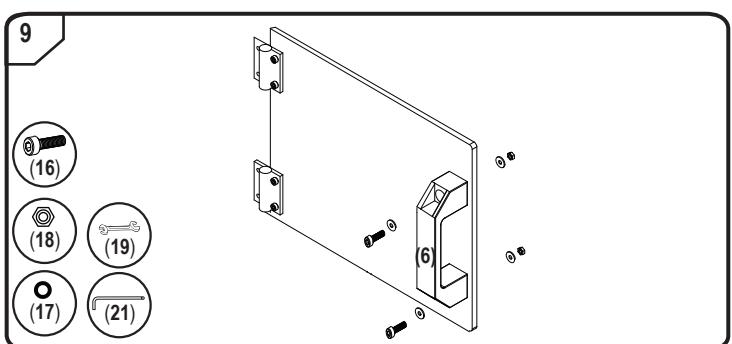
• Étape 9 : Serrez la vis (16) avec la clé pour vis à six pans creux de 2,5 mm (21). Maintenez fermement l'écrou (18) avec la clé à fourche (19).
