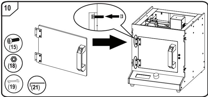
• Étape 10 : Serrez fermement la vis (15) de l'extérieur avec la clé pour vis à six pans creux de 2,5 mm (21). Maintenez fermement l'écrou (18) avec la clé à fourche (19) de l'intérieur.
