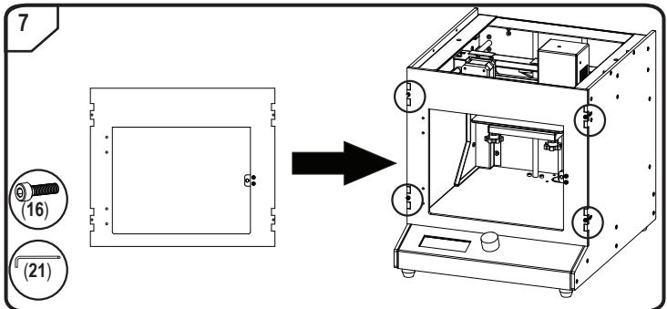
• Étape 7 : Lorsque vous serrez les vis (16), veiller à ce que les vis tournent dans les écrous utilisés dans les étapes 2 et 4.
