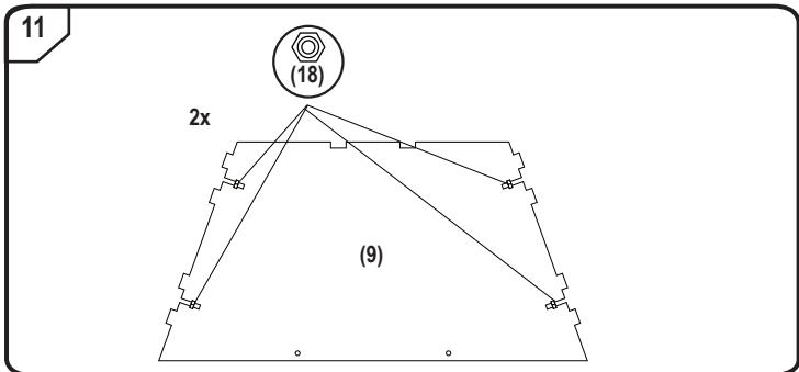
• Étape 11 : Insérez un écrou (18) dans chacune des encoches de la partie latérale (9).
