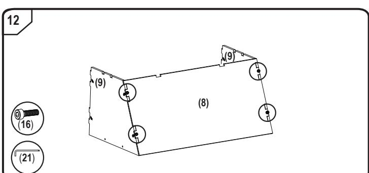
• Étape 12 : Lorsque vous serrez les vis (16), veiller à ce que les vis tournent dans les écrous utilisés dans les étapes 12.
