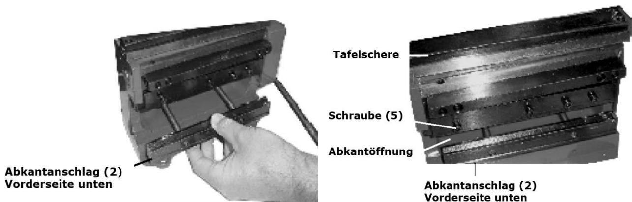
Die Vorderseite des Abkantanschlags(2) wie oben abgebildet montieren.
