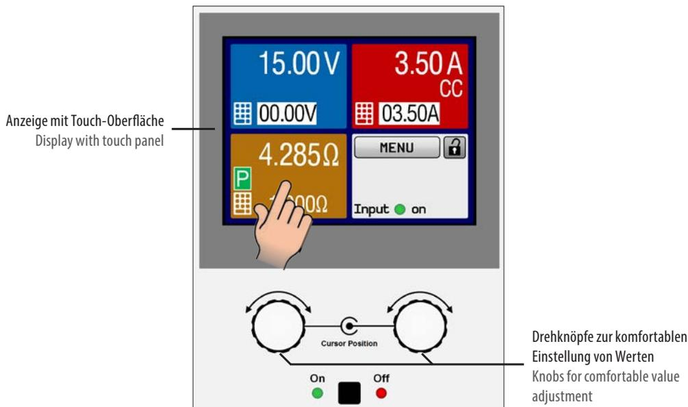
Istwerte und Sollwerte von Eingangsspannung, -strom und -leistung werden auf einem Grafikdisplay übersichtlich dargestellt. Die farbige TFT-Anzeige ist berührungssensitiv und ermöglicht intuitive Bedienung aller Funktionen des Gerätes.
