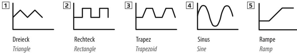
Zusätzlich zu den Standardfunktionen, die auf einem sogenannten Arbiträrgenerator basieren, ist dieser arbiträre Generator offen zugänglich, um komplexe Abläufe für z. B. Produktprüfungen aus bis zu 100 Sequenzen erstellen und ablaufen lassen zu können. Diese Sequenzen können mittels USB-Stick und dem USB-Port am Bedienfeld gespeichert und geladen werden, um so einen schnellen Wechsel zwischen verschiedenen Test- bzw. Prüfsequenzen zu ermöglichen.
