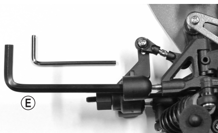
Serrer/desserer la vis sans tête en plastique (C)
