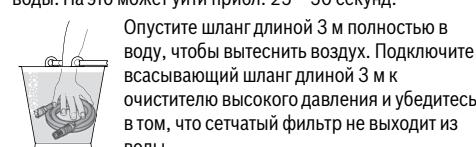
Дайте очистителю высокого давления поработать без пистолета, пока вода из шланга высокого давления не польется равномерным потоком. Если через 25 – 50 секунд вода не льется, выключите электроинструмент и проверьте все соединения. Если вода льется, выключите очиститель высокого давления и подключите пистолет-распылитель и трубку для работы.
