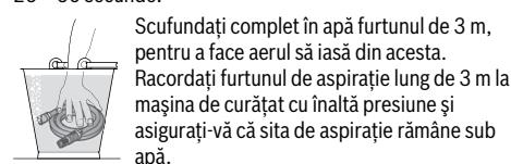
Lăsați mașina de curățat cu înaltă presiune să funcționeze cu pistolul de stropit demontat, până când, din furtunul de înaltă presiune apă curge uniform. Dacă după 25 – 50 secunde încă nu curge apă, deconectați mașina și verificați toate conexiunile. Dacă curge apă, deconectați mașina de curățat cu înaltă presiune și racordați pistolul de stropit și lancea pentru a lucra.
