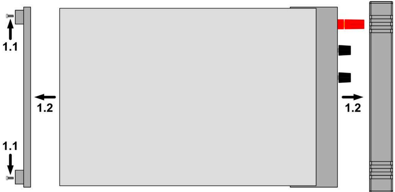
Bild 7 - Abnehmen des Front- und Rückseitenrahmens
