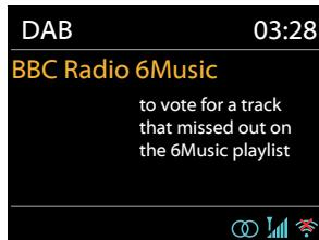
Mentre si sta riproducendo la radio DAB, il display mostra informazioni relative al brano corrente. Per visualizzare ulteriori informazioni, premere **INFO**. Ogni volta che si preme **INFO**, è visualizzato un altro set di informazioni, che mostra ciclicamente testo DLS, potenza di segnale, tipo di programma, nome gruppo, numero canale/frequenza, frequenza errore segnale, bit rate/codecs, ora e data.
