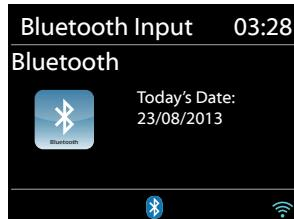
Pour accéder au **mode Bluetooth**, appuyez sur **Home** pour choisir **Bluetooth** puis appuyez sur **OK**. Quand vous sélectionnez le mode Bluetooth, l'appareil entre en mode couplage. Allumez votre smartphone/tablette/autre appareil Bluetooth pour rechercher la radio. Le nom du couplage Bluetooth de l'adaptateur radio est «DR 890 CD». Si le couplage est réussi, «Connected» s'affiche à l'écran et CD DR 890 lance la lecture à partir de votre appareil.
