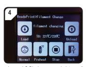
• Im LC-Display erscheint Statusanzeige < filament changing >. 3D Drucker ist nun bereit zum Filamenteinzug.
